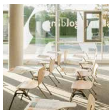
Der textile Bodenbelag trägt wesentlich zur Erfüllung der hohen Anforderungen an die Raumakustik bei.
